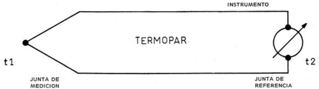
Figura 1.2. Representación gráfica de un termopar.
